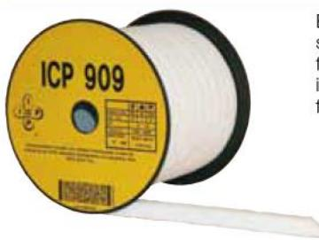
Empaquetadura trenzada con sistema intertrenzado a base de filamentos de PTFE expandido impregnados con lubricantes, fibra 100% Gore-Tex®.
