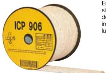
Empaquetadura trenzada con sistema intertrenzado a base de hilos de lino de alta pureza impregnados con PTFE y lubricante de rodaje.
