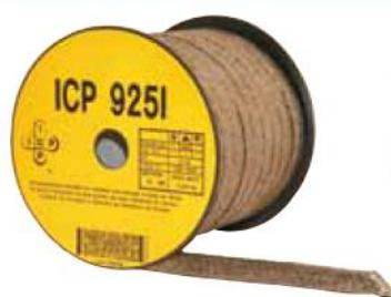
Empaquetadura trenzada con sistema intertrenzado a base de cintas de grafito expandido de alta pureza con bajo contenido en cloruro, inhibidor de corrosión e inserción de filamentos de inconel.
