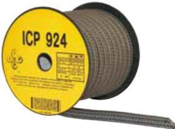
Empaquetadura trenzada con sistema intertrenzado con filamentos de PTFE expandido impregnados con grafito y lubricante, 100% fibra GFO® "Gore-Tex®", doblados sobre un filamento de aramida continua con impregnación de PTFE "Twaron®".
