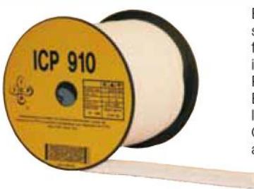
Empaquetadura trenzada con sistema intertrenzado a base de filamentos de PTFE expandido impregnados con dispersión de PTFE, fibra 100% Gore-Tex®. Esta empaquetadura cumple las normas para trabajos en Oxígeno, así como en la industria alimentaria (FDA).
