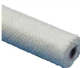
Empaquetadura trenzada a base de hilos sintéticos de alta calidad con interior de elastómero de altas prestaciones y un forro trenzado de filamentos de PTFE. Especialmente diseñada para aplicaciones como junta estática en compuertas, depósitos, etc.
