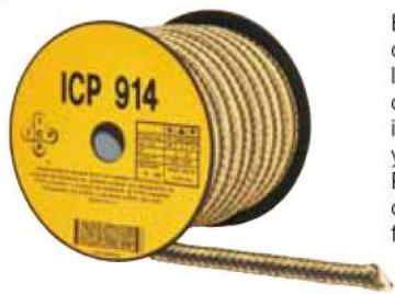
Empaquetadura trenzada mixta con sistema intertrenzado, en las esquinas con filamentos de aramida continua con impregnación de PTFE "Twaron" y en el centro con filamentos de PTFE expandido impregnados con grafito y lubricante "100% fibra GFO® (Gore-Tex®)".
