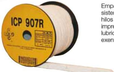
Empaquetadura trenzada con sistema intertrenzado a base de hilos de ramio de alta calidad impregnados con PTFE y lubricante de rodaje totalmente exento de silicona.
