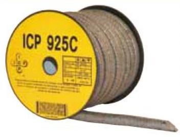
Empaquetadura trenzada mixta con sistema intertrenzado a base de cintas de grafito expandido de alta pureza y bajo contenido en cloruro, inhibidor de corrosión y filamentos de carbono de alta calidad en las esquinas.
